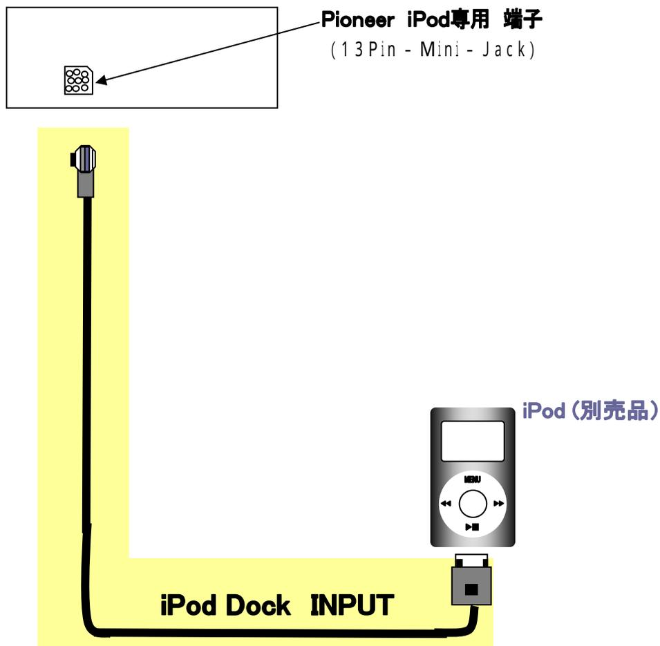
**仕様** 当機は、パイオニアFULL SPEED 13Pinミニジャック(iPod専用)と接続し、デッキにてiPodをコントロールできるiPodインターフェイスです。
